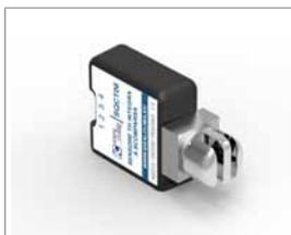
Sensor integrado de temperatura y humedad relativa, con precisión de 0,5 °C y 4,5% respectivamente, con fijación universal oculta adecuada para todo tipo de cubierta de módulo eléctrico de la serie civil de las principales marcas comerciales, con cubierta de sensor en aluminio anodizado. Rango de medición 0-70 ° c, 0-100% humedad relativa. Se conecta a Integra Control Clima hasta una distancia de 30 m.
