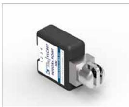
Sensor integrado para la Prevención de moho en las estructuras internas del edificio, con cierre retráctil universal apto para las principales marcas eléctricas, con cubierta de sensor en aluminio anodizado. Rango de medición de humedad relativa 0-100%, histéresis  $\pm 1\%$ , clase de protección IP30 algoritmo de calibración continua y sin necesidad de calibración manual.
