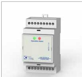
Equipado con salida de 0-10 V para la gestión de modulación de una compuerta, 2 contactos limpios para la gestión de una compuerta ON/OFF, para la gestión del consentimiento al fan coil, o para el control de una válvula de 2 o 3 vías. Dos LED a bordo, verde y rojo, dan una señal inmediata del estado de funcionamiento del dispositivo (rojo = anomalía). Interactúa con Integra Benessere o con sistemas domóticos de terceros a través de un puerto serial RS485 estándar con protocolo Modbus RTU.
