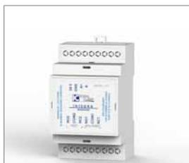
Dispositivo de control digital para la gestión de dos contactos limpios a cambio, con la función de generación de consentimiento caliente / frío y contacto verano invierno. Consumo máximo de energía inferior a 1 W. Fuente de alimentación de 24 V CC. Relé con potencia de rotura de 10 a 230 V. Instalable en cuadro eléctrico. Diálogo con Integra Touchscreen o con sistemas domóticos externos con protocolo Modbus RTU.
