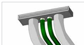
EG. LÍNEA VENT CON RED AÉREA HRV (VERDE) RED HIDRÓNICA (GRIS)
